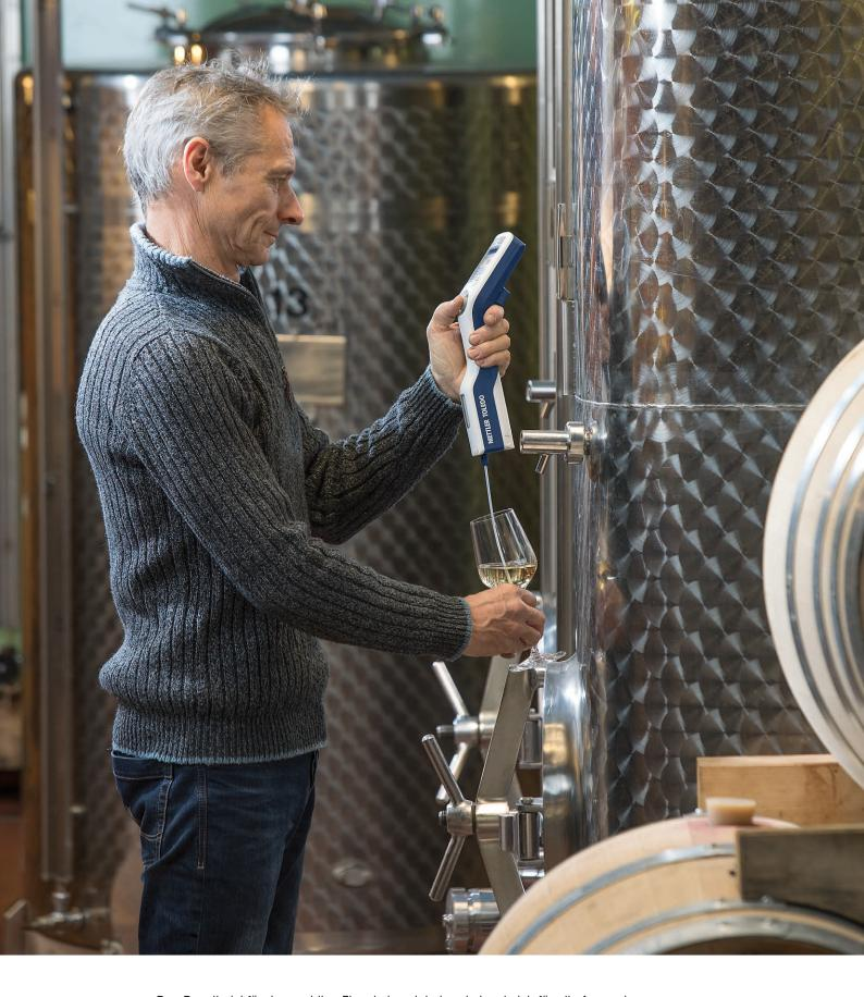
Das Densito ist für den mobilen Einsatz konzipiert und eignet sich für alle Anwendungen: nicht nur für die Prüfung der Reife oder Gärung von Trauben, sondern auch für die Prüfung der Qualität der eingehenden Waren oder der Endprodukte. Messen Sie Dichte, spezifisches Gewicht, Brix und weitere Größen mit Hilfe von integrierten Berechnungen am Gerät. Sein einzigartiges Design ermöglicht eine Einhandbedienung, so dass Sie Ihre zweite Hand frei haben, um Sie bei der Probenahme zu unterstützen.
