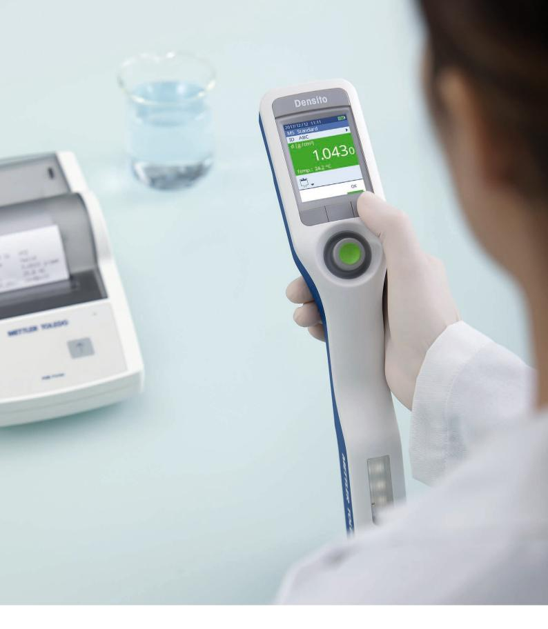
Die Dichte einer Flüssigkeit kann bei der Qualitätskontrolle als eindeutiges Identifizierungsmerkmal dienen. Stellen Sie höchste Qualität sicher, indem Sie einen Bereich mit Grenzwerten für akzeptable Proben definieren: Ergebnisse, die in diesen Bereich fallen, sind farbkodiert und ermöglichen eine sofortige Identifizierung akzeptabler Proben.
